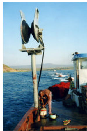
Figure 35 Moteur hydraulique sur un bateau senneur basé à Mpulungu
