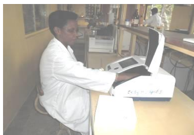
Spectrophotomètre 6715 UV-VIS JENWAY
