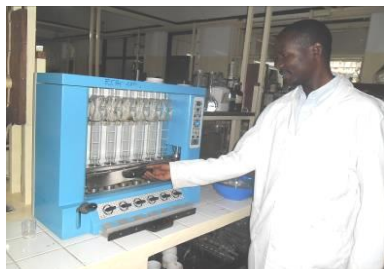
Unité d'extraction des fibres/cellulose FIWE 6, VELP Scientifica
