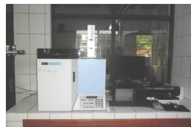
Analyseur CHNS/O Perkin Elmer 2400 série II
