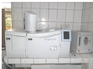
Chromatographe en phase gazeuse CLARUS 580 GS Perkin Elmer couplé à un Spectromètre de masse Clarus 560 S
