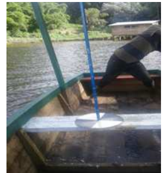
Disque de Secchi graduée jusqu'à 60 Cm
