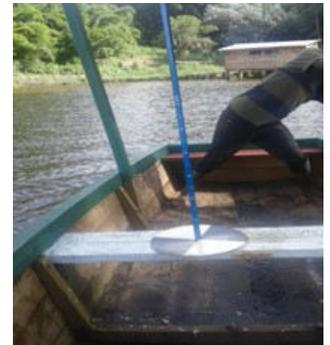
Disque de Secchi graduée jusqu'à 60 Cm
