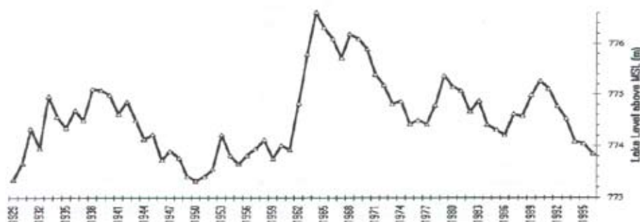
Fig. 67: Fluctuations du niveau annuel moyen du lac Tanganyika de 1929 à 1996 (Verbug et al. 1997, in Ntakimazi, 2008)
