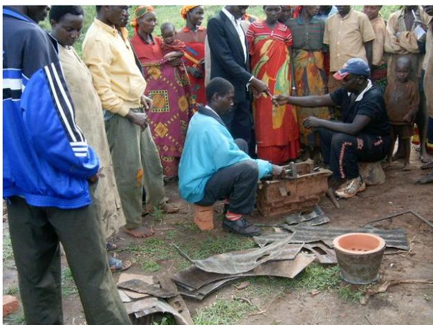
**Fig. 12: Ces membres de l'Association Dusanure Ivyasambutse sont en train être formés en matière du coupage du tôle métallique de protection et leur assemblage autour d'une céramique.**
