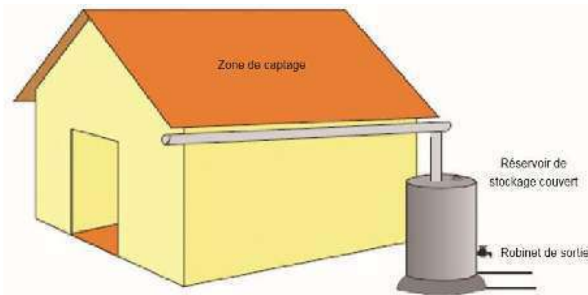
Figure 31: Caractéristiques de base d'un système CEP pour une maison individuelle
