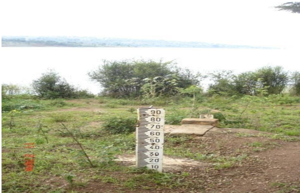
Photo n° 1: Photo sur le Lac COHOHA : Vue des échelles millimétriques qui étaient auparavant submergés et qui restent maintenant à découvert. Source : Institut Géographique du Burundi (IGEBU).
