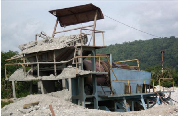
**FIGURE 1** Dispositif de broyage d'agrégats dans un site d'exploitation semi-mécanisée de l'or à l'est du Cameroun (Bétaré-Oya) (Photo NTEP Rigobert)
